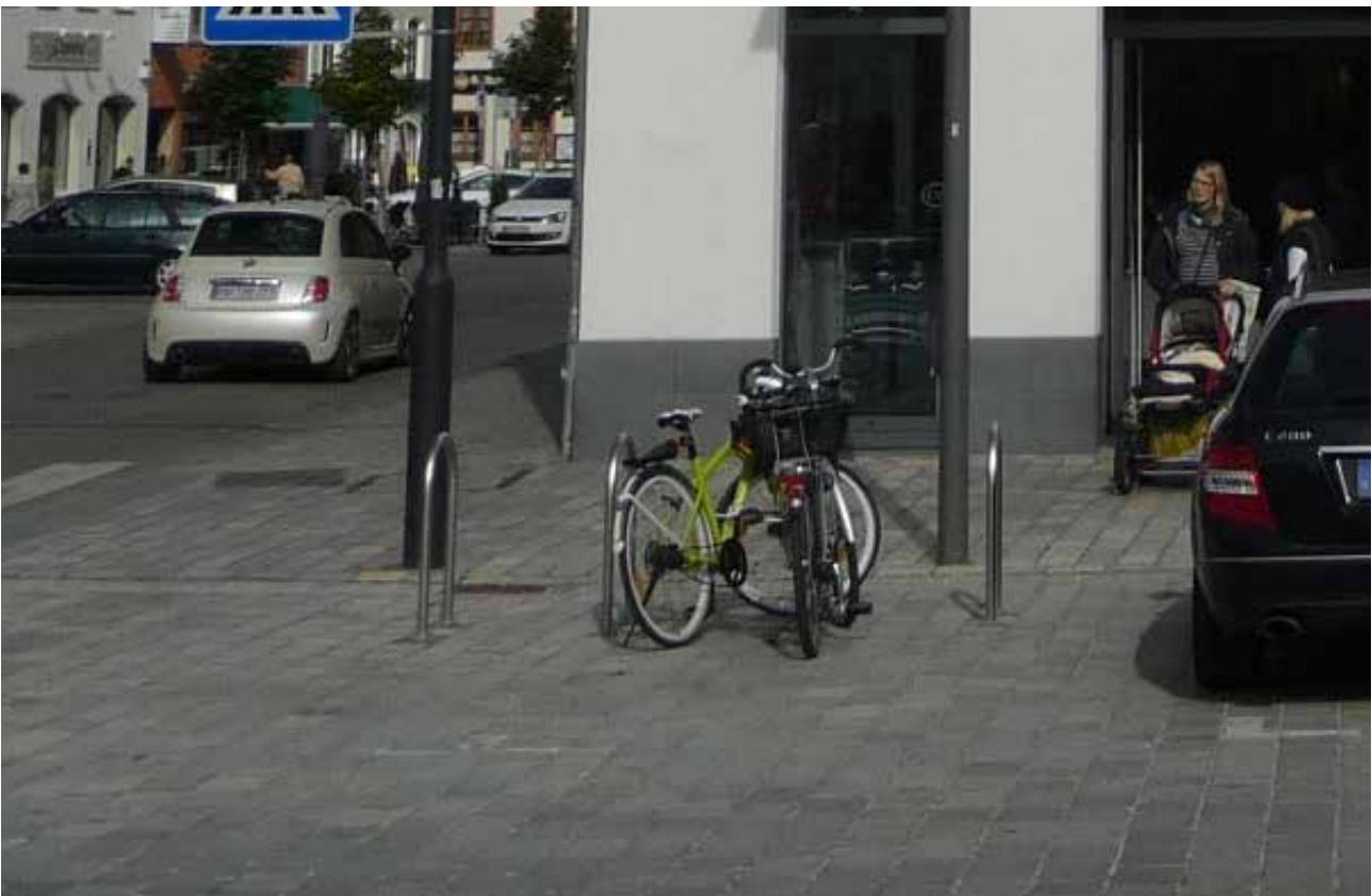
Abb. Die in Pfaffenhofen a. d. Ilm am Hauptplatz verwendeten Anlehnbügel aus Edelstahl sollten in der gesamten Innenstadt im öffentlichen Raum verwendet werden. Bei ausreichendem Achsabstand (1,20 m) sind sie beidseitig und somit wirtschaftlich zu nutzen.
