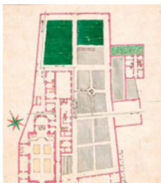
Grundriss der Klosteranlage mit Hervorhebung der Grünflächen und Gartenbereiche sowie der Wasserleitungen mit Laufrichtung, gezeichnet von Pater Angelicus Dalber OFM (um 1780) (Bayerische Historische Anstalt, Planzeichnung 2307)
