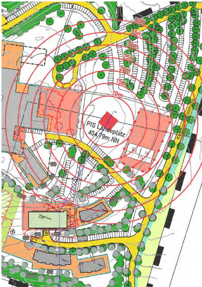
Abb. Übersicht zu Angaben zulässige Hindernishöhen PIS Hubschrauber-Landeplatz (Radienbeurteilung) mit Schnittführung Geländeschnitt geplante Pflugeschule
