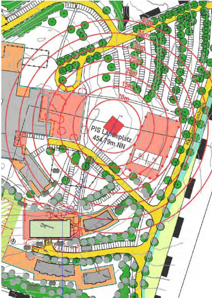
Abb. Übersicht zu Angaben zulässige Hindernishöhen PIS Hubschrauber-Landeplatz (Radienbeurteilung) mit Schnittführung Geländeschnitt geplante Pflanzschule
