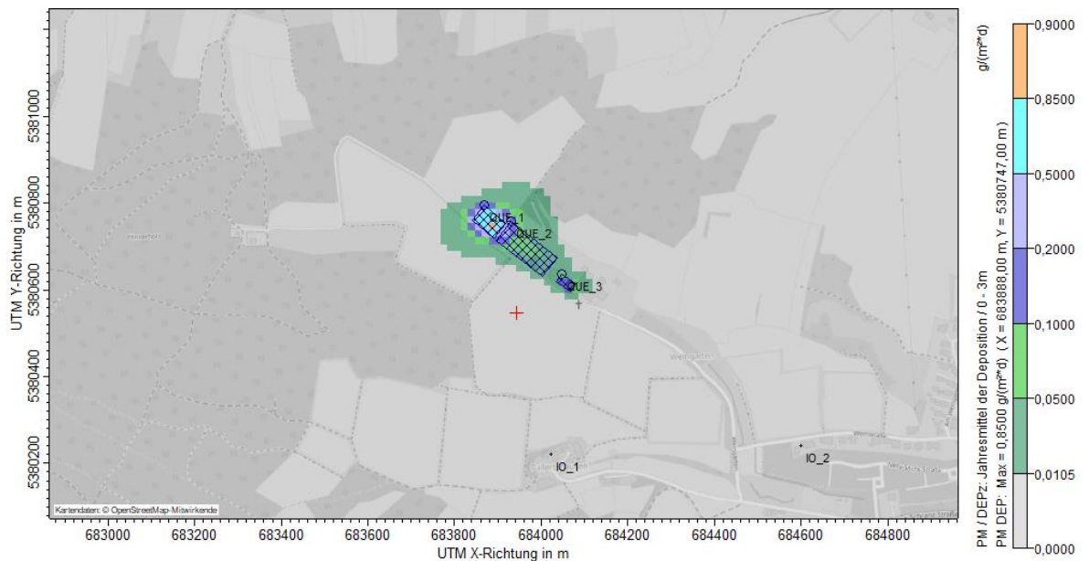
Abbildung 7. Zusatzbelastung durch Staubbiederschlag im Jahresmittel. Die Irrelevanzschwelle gem. TA Luft beträgt 10,5 \text{ mg}/(\text{m}^2 \times \text{d}) [2]. Nächstegelegene Immissionsorte (IO_1 und IO_2) mit grünen Punkten markiert; Kartenhintergrund [6]
