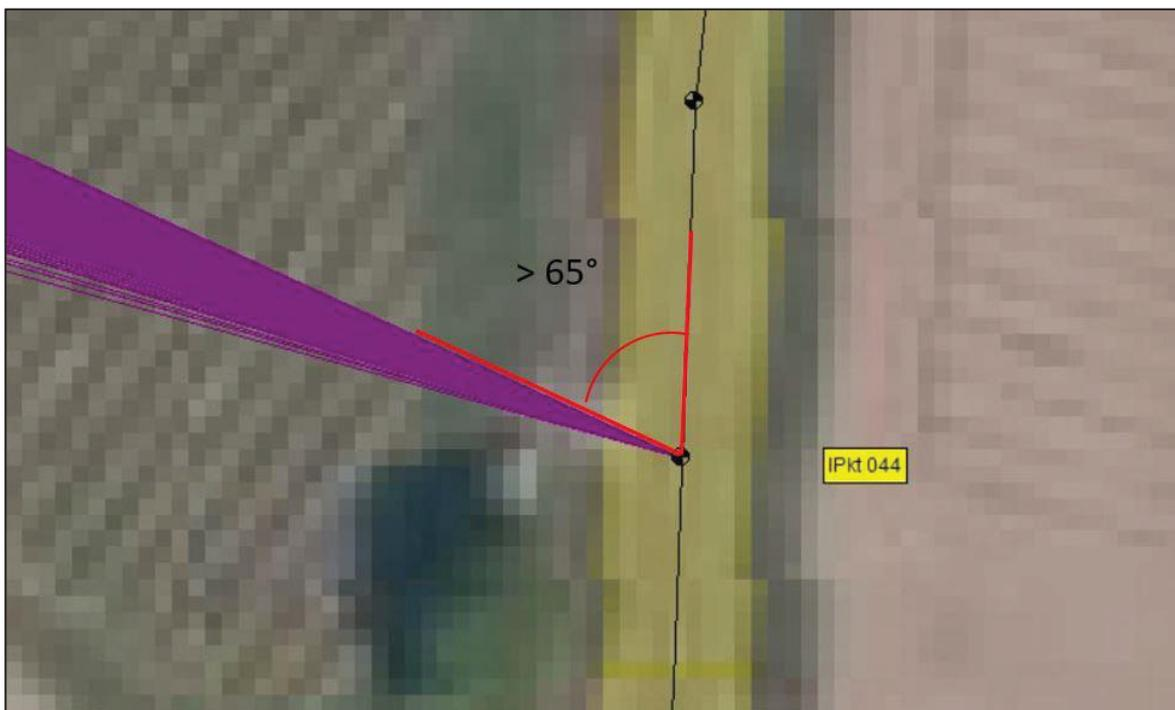
**Abbildung 3: Darstellung der Reflexionsstrahlen auf IPkt 044**
