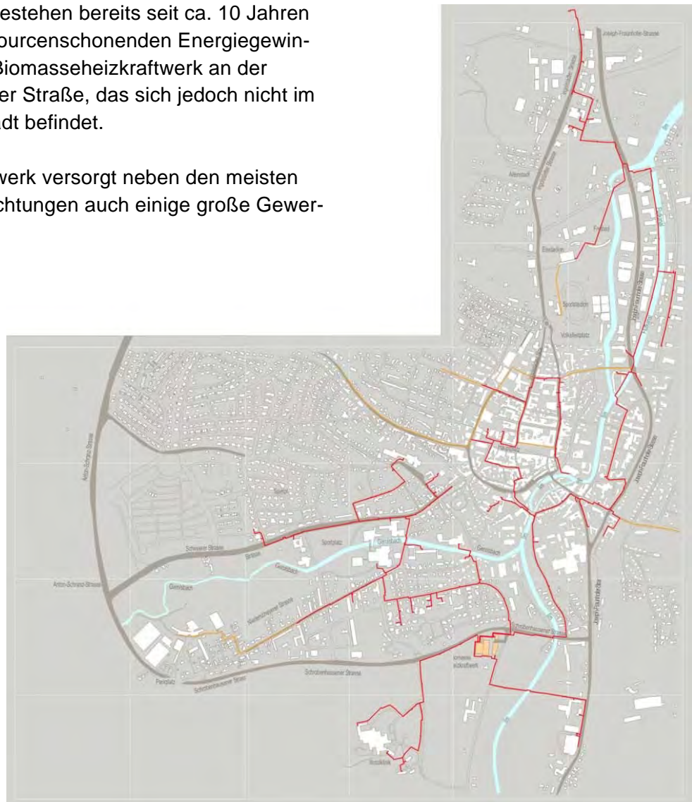
Fernwärmenetz des Biomasseheizkraftwerks Pfaffenhofen a. d. Ilm
