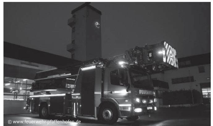
Neu sind die fest verbaute Wasserführung bis in den Korb der Drehleiter sowie der fernsteuerbare Wasserwerfer. Bisher mussten durch zwei Feuerwehrleute zuerst im Korb ein Wenderohr aufgebaut und der Schlauch im Leiterteil verlegt werden. Zukünftig muss der Schlauch nur noch am Fahrzeugende an der vorgesehenen Festverrohrung angeschlossen werden. Der Wasserwerfer wird jetzt vom Bedienstand des Maschinisten am Boden gesteuert.
